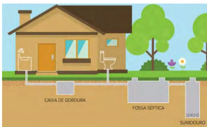
Figura 76: Esquema representativo do sistema Tanque/ Fossa séptica e Sumidouro
