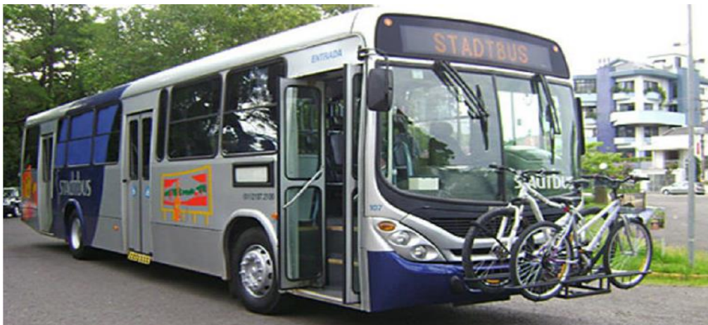
Figura 39 – Ônibus adaptado para transporte de bicicletas.
