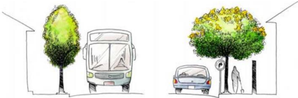
FIGURA 57 – Árvores e suas respectivas alturas próximas a imóveis. Note a importância na altura da copa da árvore, em relação ao pedestre e placa de sinalização de trânsito.
